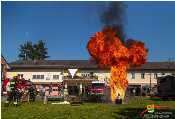
Fettbrand mit ca 100 ml Wasser als Löschmittel
